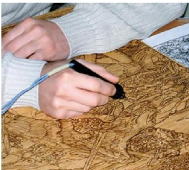
Ручку с нагревательным пером берут в правую руку как карандаш. Прибор включают в электрическую сеть и переключателем устанавливают необходимую степень накала пера. Начинают работать тогда, когда перо разогреется до темно-красного цвета. Выжигать можно только по сухой древесине.
